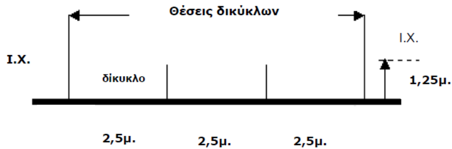
Εικόνα 1: Γεωμετρικά χαρακτηριστικά παράλληλης στάθμευσης δικύκλων
